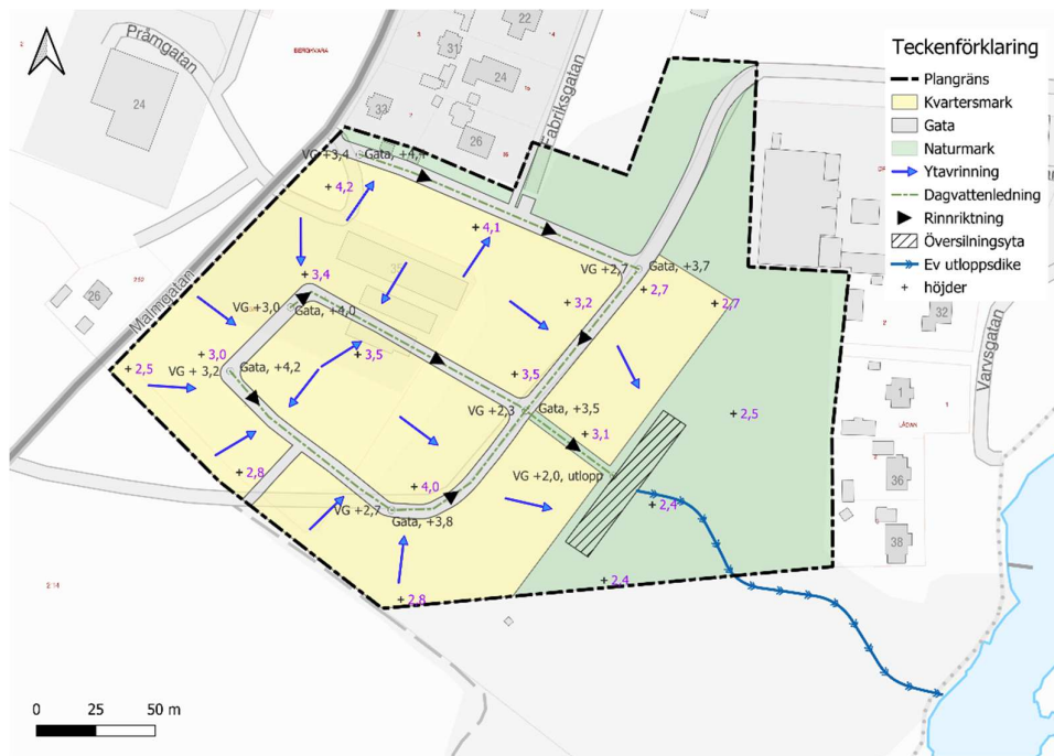
Figur 2 Förordad dagvattenhantering, + höjd för befintlig mark med lila siffror.
