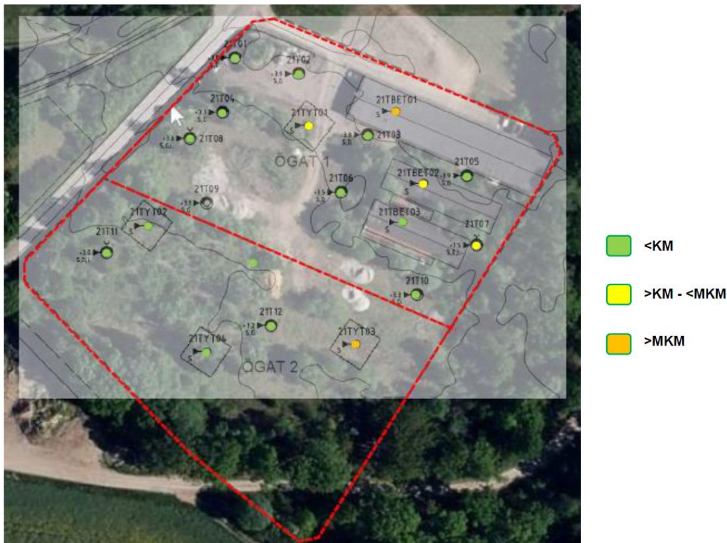
Figur 5. Kopia på figur från Tyréns rapport (2021) som visar resultat från jord och betonganalyser. Grön markering visar halter under KM. Gul markering visar halter över KM men under MKM. Orange markering visar halter över MKM. Källa: Tyréns, 2021.
