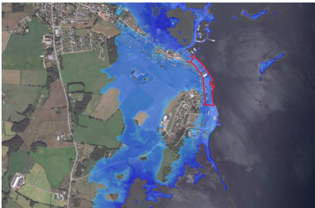
Figur 12. En analys av hur de södra delarna av Bergkvara drabbas av havsnivåhöjning av 2.8 meter.
