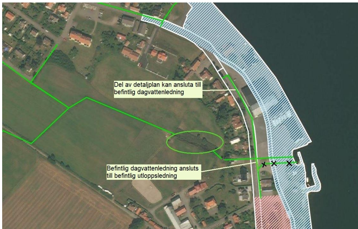
Figur 15. Dagvattenlösning för nordvästra delen av planområdet.
