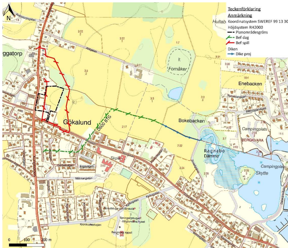
Figur 6 Planområde och nedströms dagvattenanläggningar.
