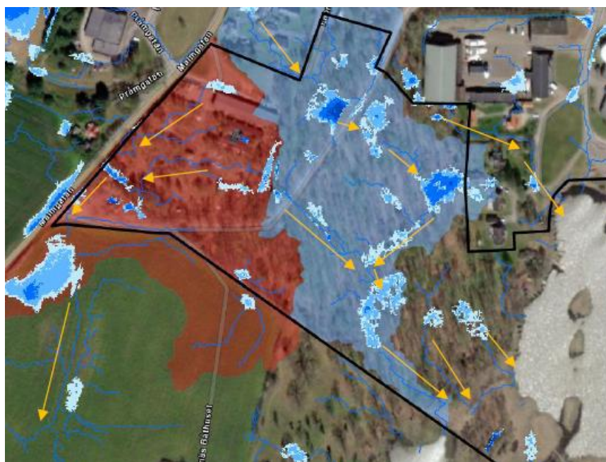
Utdrag ur Tyréns dagvattenutredning (2023-03-21). Blåmarkerat område avrinner öster ut, rödmarkerat område avrinner åt sydväst.
